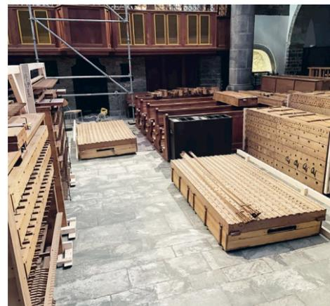
réparés. Sur les tuyaux de bois, les joints décollés ont été réparés et la bonne fixation des blocs a été contrôlée.
